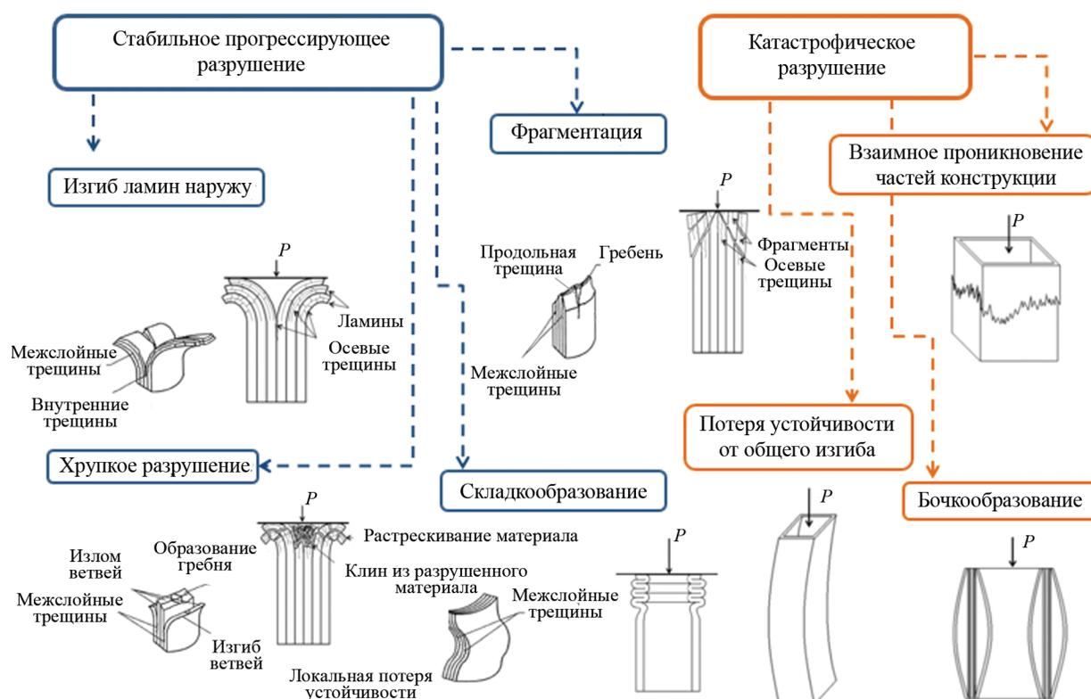
Рис. 9. Формы разрушения конструкций из ПКМ, используемые при анализе аварийной прочности
