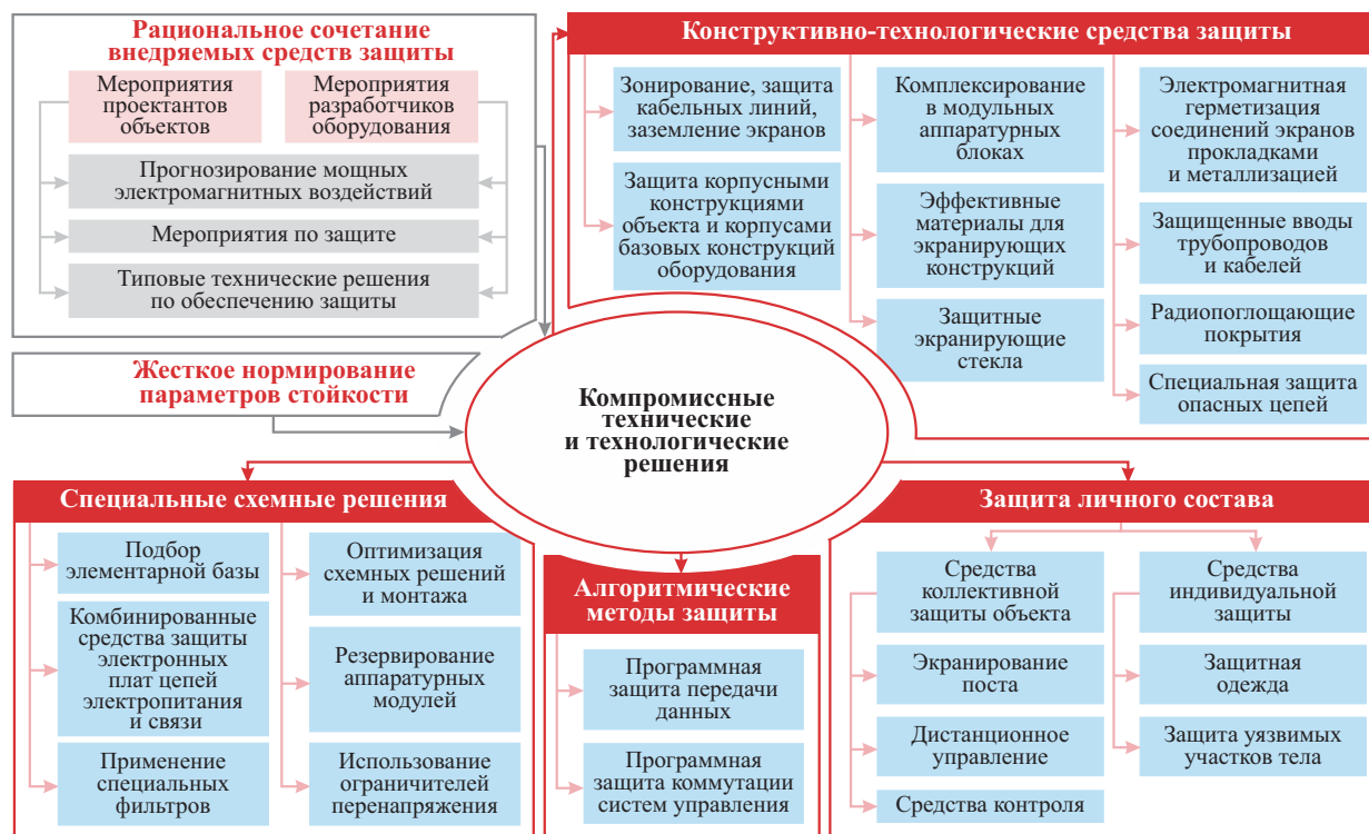
Рис. 2. Структура разработанной технологии обеспечения электромагнитной безопасности морских технических объектов
