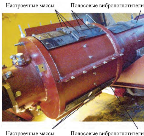
**Рис. 6.** Трубчатая конструкция с резонирующими полосовыми вибропоглотителями
