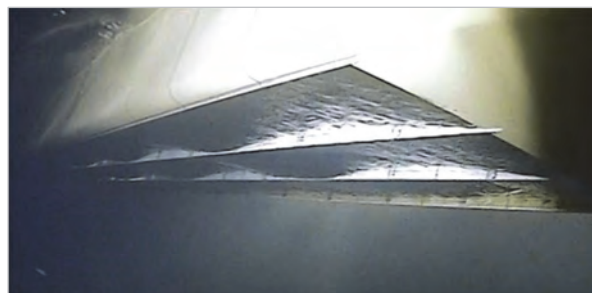
Рис. 5. Воздушная каверна на скорости 15 уз Fig. 5. Air cavity at the speed of 15 knots
