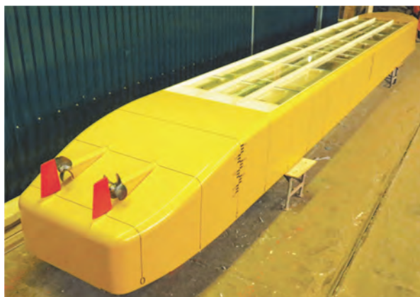
Рис. 3. Модель судна с искусственной каверной Fig. 3. Model of ship with artificial cavity
