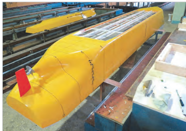
Рис. 4. Модель универсального навалочника-контейнеровоза с устройством для создания каверны Fig. 4. Model of multi-purpose bulker / containership with device for air cavity generation
