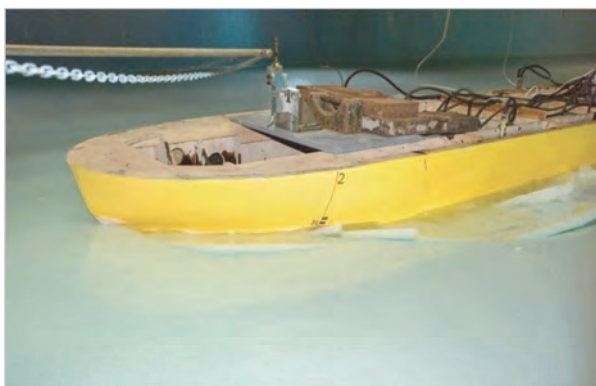
Рис. 9. Модель с каверной при испытаниях в ледовом опытовом бассейне
