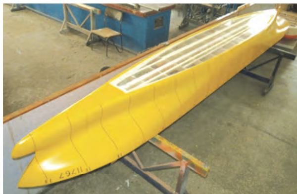
Рис. 10. Модель контейнеровоза с рецессом Fig. 10. Model of containership with recess
