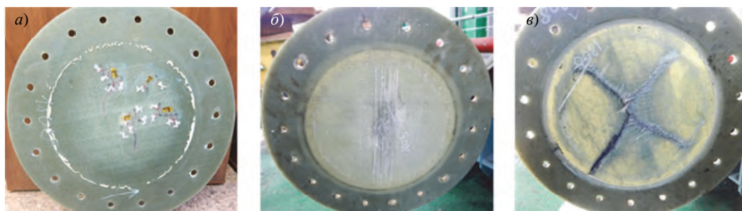
Рис. 12. Характерные виды разрушения образцов из стеклопластика (группа 1): а) разрушение связующего, вид на тыльную поверхность ( Q = 8 г, \beta = 0,44 %, \delta = 7,32 мм, m = 14,49 кг/м 2 ); б) разрыв волокон трех слоев с тыльной стороны ( Q = 70 г, \beta = 3,83 %, \delta = 7,40 мм, m = 14,50 кг/м 2 ); в) пробоина, вид на лицевую поверхность ( Q = 55 г, \beta = 4,20 %, \delta = 5,20 мм, m = 10,40 кг/м 2 )
