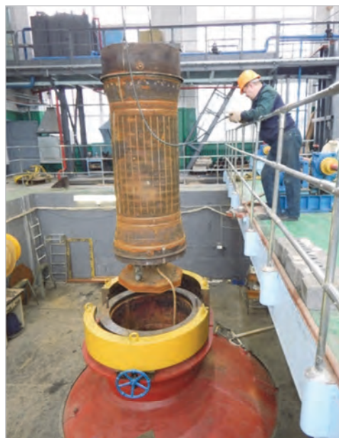
Рис. 1. Загрузка опытного образца оболочки во взрывную камеру
