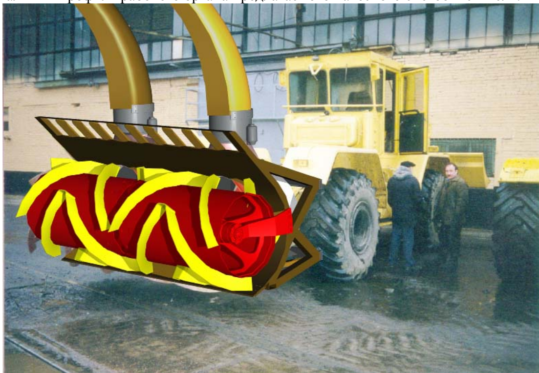
Рис. 1. Общий вид модернизированного снегоочистителя на базе трактора «Кировец».
