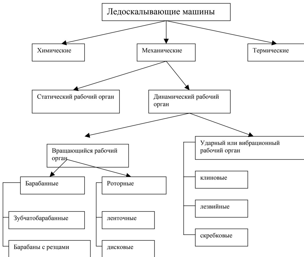
Рис. 1. Классификация ледоскалывающих машин.
