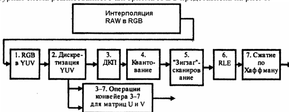
Рис. 1. Структурная схема алгоритма JPEG
