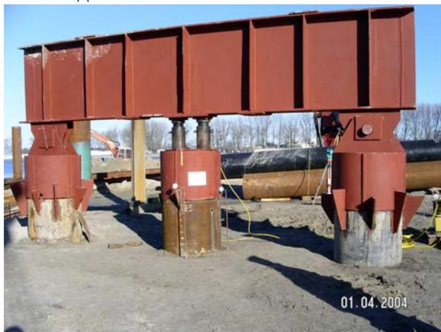
Рис. 1. Испытание свай
