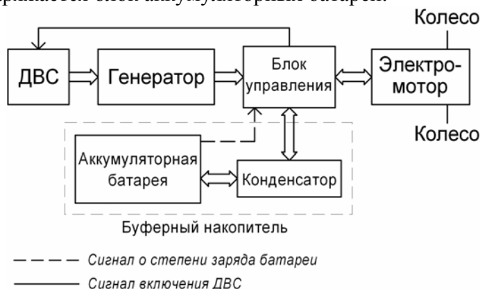
Рис. 2. Схема гибридной силовой установки
