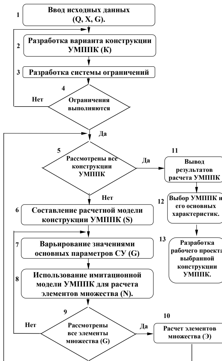
Рис.7. Структурная схема алгоритма выбора конструкции УМППК и ее основных параметров.
