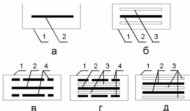
1 - кассета; 2 - радиографическая пленка; 3 - усиливающий флуоресцирующий экран;
