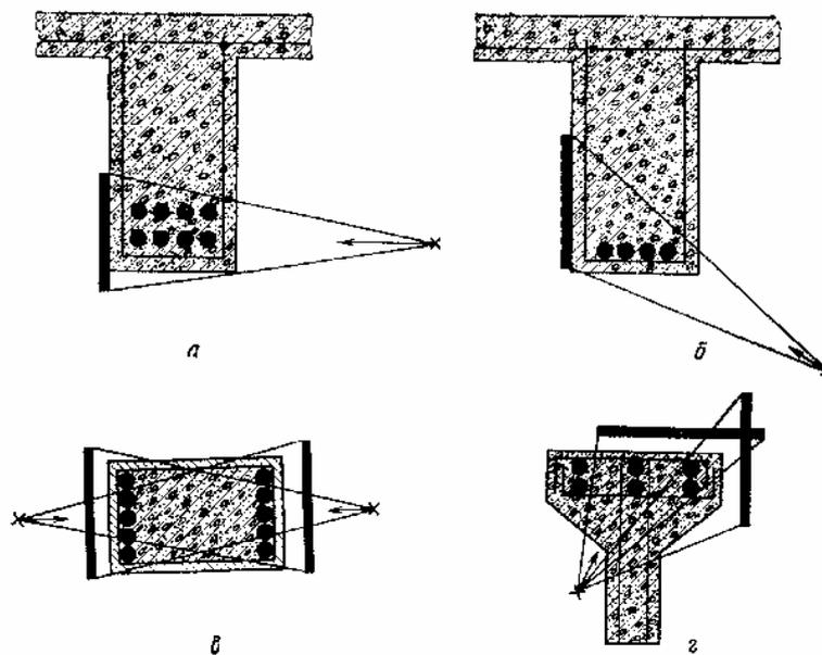
а - балка ребристого перекрытия при двухрядном расположении арматуры;
