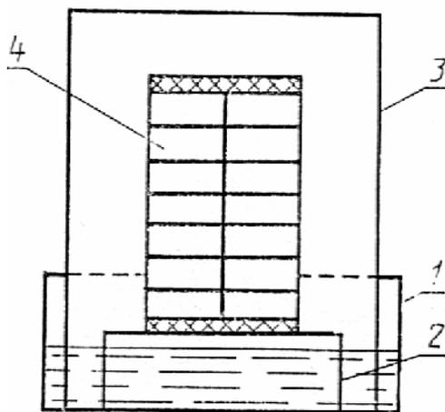
1 - сосуд-основание с водой; 2 - подставка для укладки образцов;
