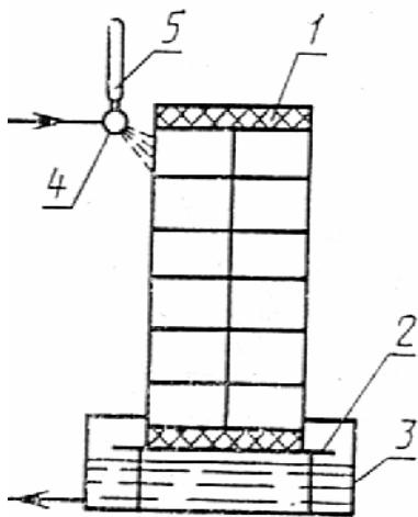
1 -фрагмент ограждающей конструкции в сквозной съемной теплоизолирующей запорной раме или в кассете контейнера АДОЗО;
