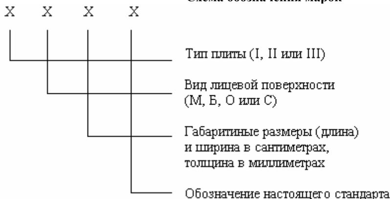
Пример условного обозначения декоративной плиты из природного камня I типа с мозаичной лицевой поверхностью, длиной и шириной 500 мм, толщиной 30 мм:
