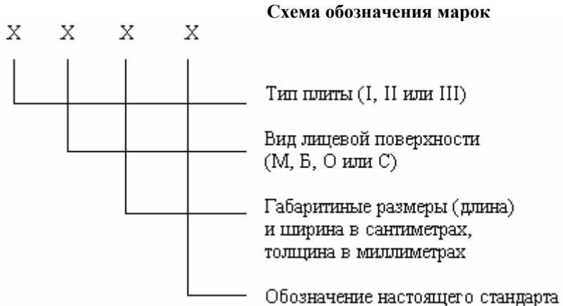
Пример условного обозначения декоративной плиты из природного камня I типа с мозаичной лицевой поверхностью, длиной и шириной 500 мм, толщиной 30 мм:
