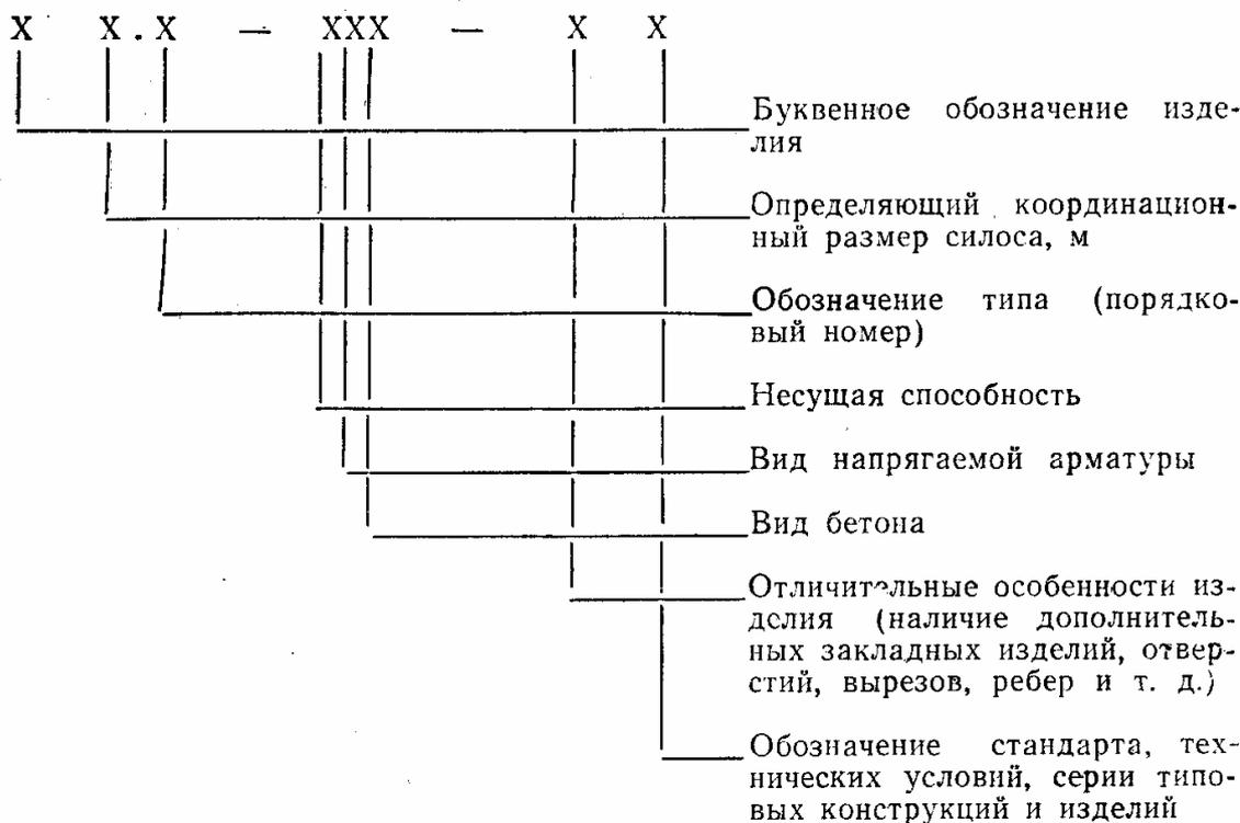
Буквенные обозначения изделий даны в справочном приложении 1. Буквенные обозначения, характеризующие вид бетона и класс напрягаемой арматуры, принимаются по ГОСТ 23009-78.
