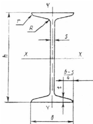
$h$  — высота двутавра;  $b$  — ширина полки;  $s$  — толщина стенки;  $t$  — средняя толщина полки;
