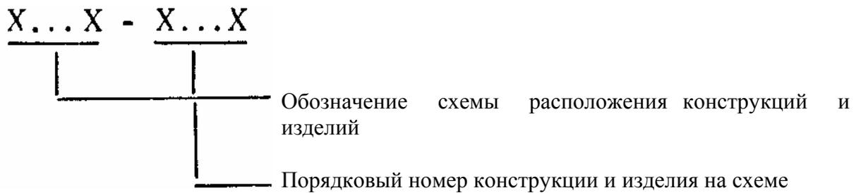
Обозначение схемы расположения конструкций и изделий состоит из одной или двух букв; при наличии нескольких схем однотипных конструкций буквенное обозначение дополняется порядковым номером.
