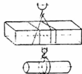
Рис. 24. Специальные строповочные тросы и стропы: а — универсальный; б — облегченный, с петлями и крючками; в — облегченные с кольцами
