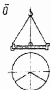
Рис. 26. Тросовый захват для транспортировки днищ и резервуаров: а — крюк захвата; б — схема строповки днища захватом
