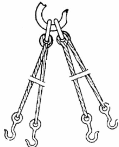
Рис. 16. Захват крючковой для перевозки цистерн
