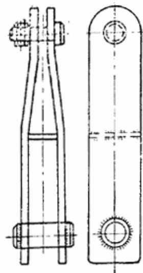
Рис. 25. Серьги для подъема тяжелых грузов
