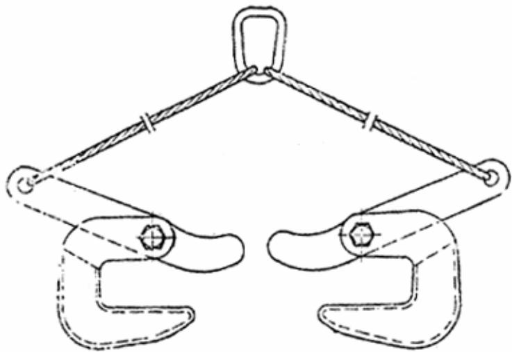
Рис. 17. Захват для листового металла типа НТ 201-00
