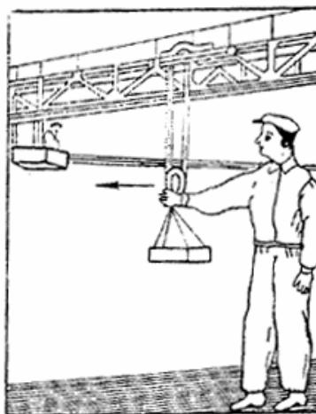
Рис 4 Передвинуть груз (мост) вперед: движение вытянутой рукой ладонью по направлению требуемого движения крана (моста)
