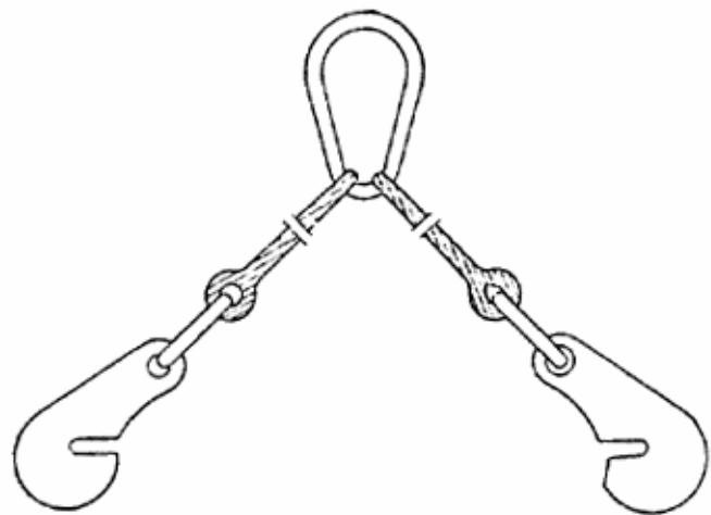
Рис. 18. Захват для листового металла типа НТ 203-00
