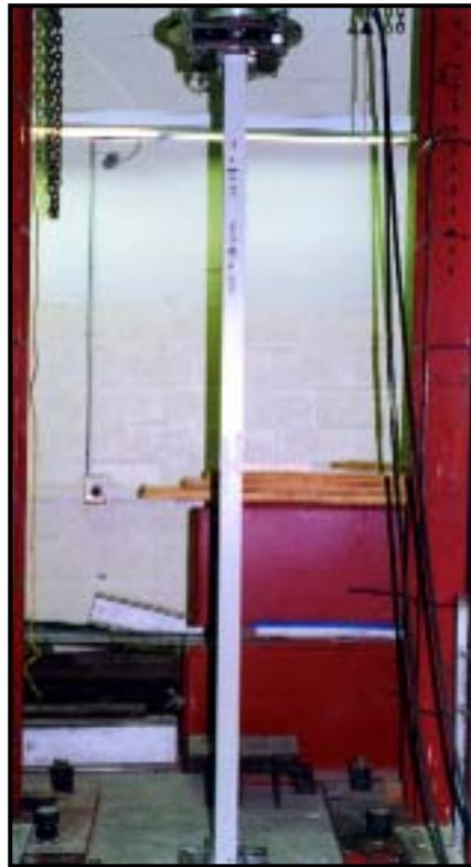
Композитные материалы для колонн создаются со смолами на полиэстеровой и винилоэстеровой основе, усиленные E-стекл. волокнами, могут быть как огнестойкими, так и нет.
