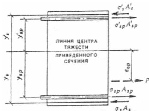
Черт. 1. Схема усилий предварительного напряжения в арматуре в поперечном сечении железобетонного элемента
