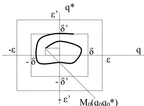
координаты  $q(t)$  и скорости  $q^*(t)$ . Эти параметры примем за координаты фазовой плоскости  $qq^*$ . Начало фазовых координат соответствует равносному положению покоя системы.
