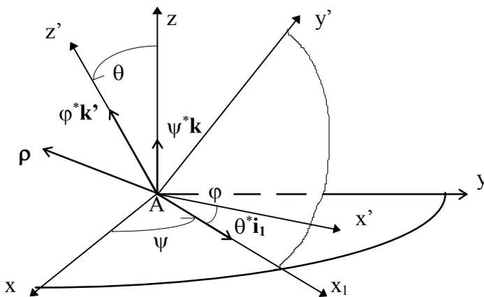
$\psi$  - угол прецессии,  $\vartheta$  - угол нутации,  $\varphi$  - угол собственного вращения (Рис.2).
