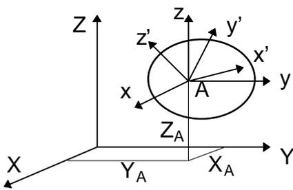
(Рис.1). Выберем в теле произвольную точку  $A$  (полнос) и поместим в ней начало осей  $x y z$ , параллельных  $X Y Z$  и движущихся с полюсом. В том же полюсе  $A$  выберем начало осей  $x' y' z'$ , связанных с телом.
