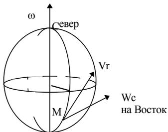
Чтобы понять природу Кориолисова ускорения рассмотрим движение точки по меридиану Земли с относительной скоростью  $\mathbf{V}_r$ . Кориолисово ускорение характеризует взаимное влияние переносного и относительного движений, которое не учитывается при подсчете отдельно переносного и относительного ускорений, поскольку
