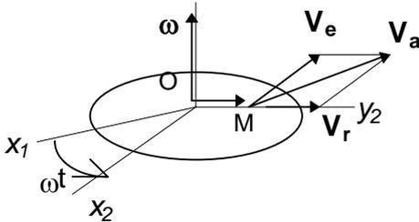
Сначала решим задачу общепринятым **методом остановки**. Мысленно остановим вращение диска и найдем проекцию относительной скорости на подвижную ось  $y_2$ , продифференцировав закон относительного движения:
