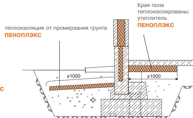
теплоизоляция от промерзания грунта
