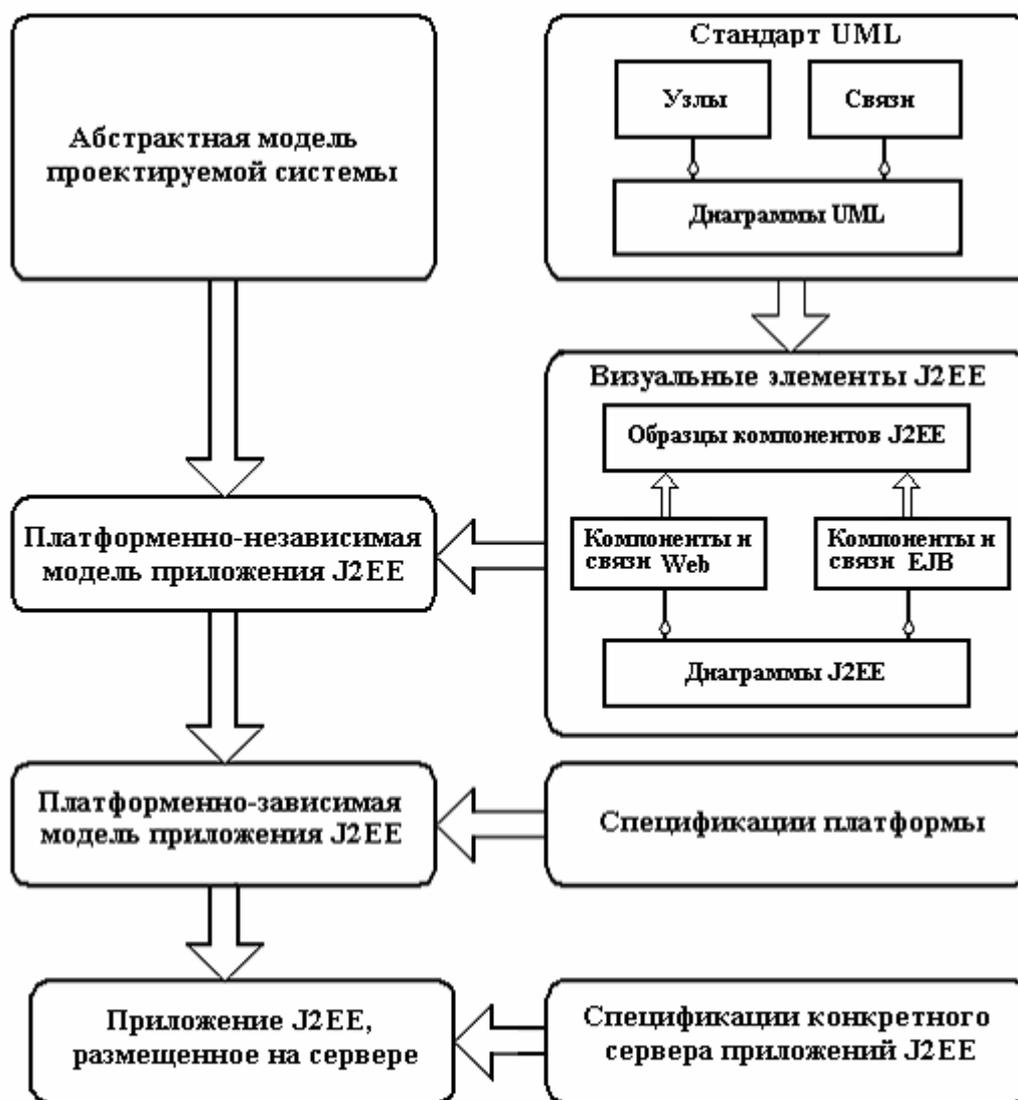
**Рисунок 1. Процесс разработки корпоративного приложения на основе MDA**
