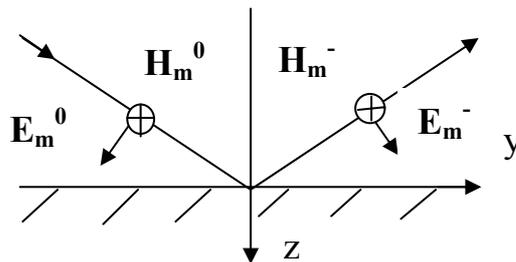
Итак, в обоих случаях поле в верхнем полупространстве имеет характер волны, распространяющейся в направлении  $y$  (множитель  $\exp(-iky \sin \varphi)$ ), а в плоскости фронта  $y = \text{const}$  распределение поля есть стоячая волна (множители  $\sin(kz \cos \varphi)$ ,  $\cos(kz \cos \varphi)$  по оси  $z$ ). В целом это плоские неоднородные волны, распространяющиеся вдоль границы. Неоднородные волны имеют поперечные и
