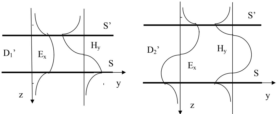
При этом внутри диэлектрического слоя на обеих его границах выполняются условия полного внутреннего отражения для однородной волны. Каждая из этих границ является импедансной поверхностью, «поддерживающей» вне слоя поверхностную волну. Плоский диэлектрический слой играет роль волновода – структуры, направляющей волновой процесс. Можно получить выражение для критической частоты для диэлектрического волновода.
