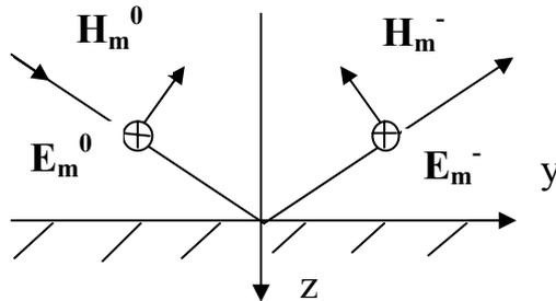
Следовательно, в верхнем полупространстве ( $z < 0$ ) поле, представляющее собой наложение падающей и отраженной волн, описывается соотношениями
