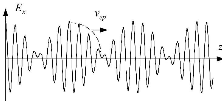
Скорость распространения сигнала найдем, зафиксировав некоторую точку на огибающей:  $\Delta\omega t - \Delta k z = \text{const}$ . Дифференцируя по  $t$  и переходя к пределу при  $\Delta\omega \rightarrow 0$ , определим групповую скорость волны  $v_{gp} = d\omega / dk$ . Ее можно рассматривать как скорость распространения огибающей сигнала (скорость переноса сигнала), если
