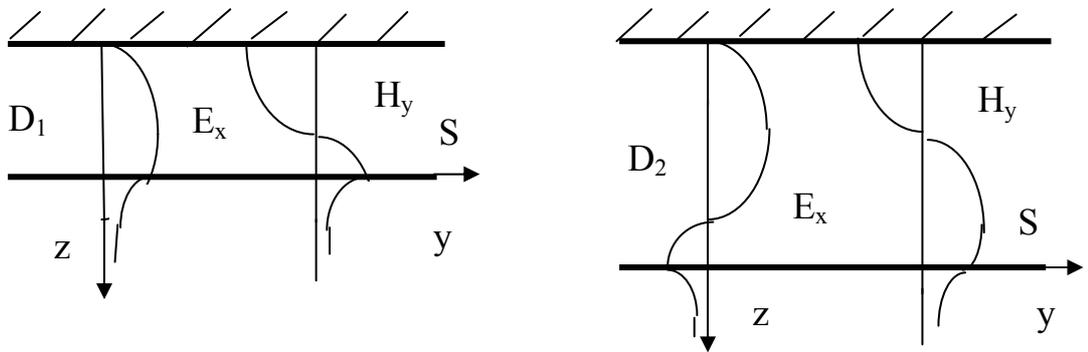
При полном отражении от границы диэлектриков  $S$  тангенциальные компоненты  $E_{\tau}$  и  $H_{\tau}$  связаны соотношением через поверхностный импеданс  $Z_s$ . В силу симметрии поля такое же соотношение между тангенциальными компонентами имеет место на определенных плоскостях  $D'$  в диэлектрике. Поэтому часть структуры, которая лежит за такой плоскостью, можно отбросить, заменив полупространством со свойствами, как при  $z > 0$ .
