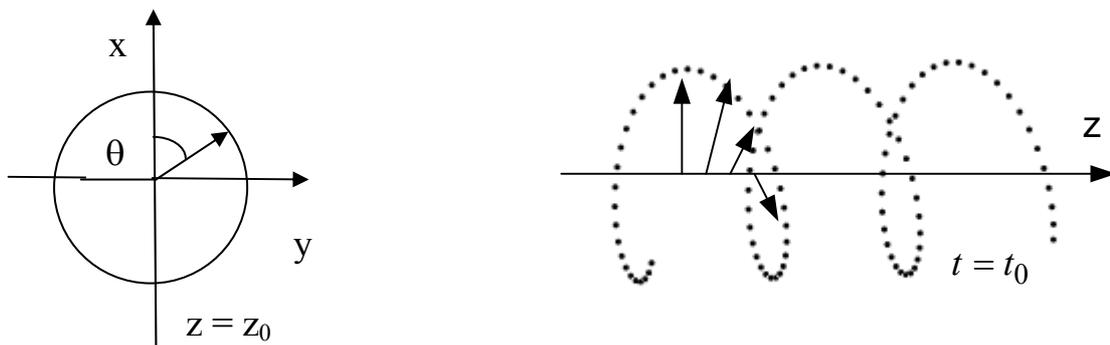
В момент времени  $t = t_0$  геометрическим местом конца вектора  $\vec{E}$  является винтовая линия с шагом  $\lambda$ . С течением времени эта винтовая линия перемещается вдоль  $z$  со скоростью  $v_{\text{ф}}$ . Волна круговой поляризации – результат наложения двух волн, поляризованных в ортогональных плоскостях, если их амплитуды равны, а фазы сдвинуты на  $90^\circ$ .
