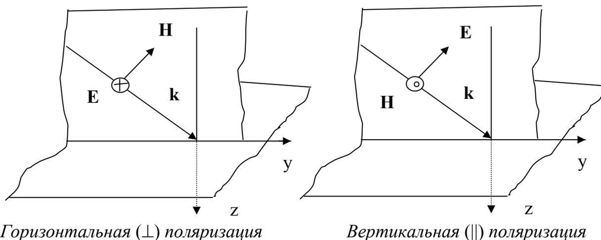
Итак, необходимо при заданной падающей волне найти комплексные амплитуды и направления распространения двух других волн, при которых тангенциальные компоненты векторов  $\vec{E}$  и  $\vec{H}$  остаются непрерывными на границе раздела сред. При отсутствии поверхностного тока касательные составляющие векторов поля
