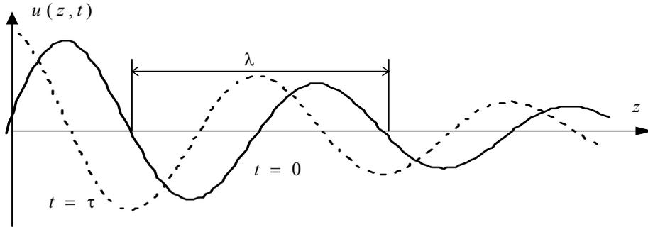
Для затухающей электромагнитной волны  $\dot{k} = k' - ik'' = \frac{\omega}{c} \sqrt{\epsilon_r \mu_r (1 - itg\delta)}$ . (Считаем,
