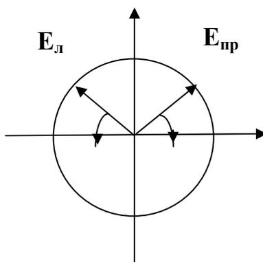
3. В общем случае амплитуда и направление вектора  $\vec{E}$  не остаются постоянными. Вектор  $\vec{E}$ , вращаясь в плоскости  $z = \text{const}$ , изменяет свою длину так, что его конец описывает эллипс. Это *волна эллиптической поляризации*.
