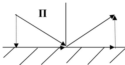
Пусть вторая среда – идеальный проводник ( $\sigma_2 \rightarrow \infty$ ,  $Z_{c2} = 0$ ). Рассмотрим падение на границу *нормально поляризованной волны*. В этом случае из формул Френеля следует, что  $R_{\perp} = -1$ ,  $T_{\perp} = 0$ . Запишем комплексную амплитуду вектора  $\vec{E}$  падающей
