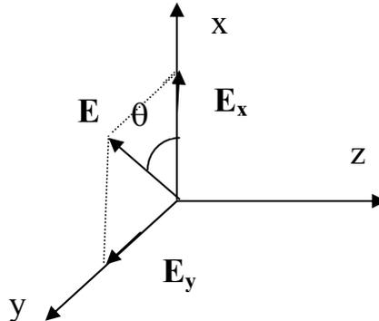
Характер изменения вектора  $\vec{E}$  волны с течением времени в фиксированной точке пространства зависит от соотношения между начальными фазами  $\varphi_1$ ,  $\varphi_2$  и от амплитуд  $E_{mx}$ ,  $E_{my}$ . В фиксированной точке пространства угол  $\theta$  определяется соотношением
