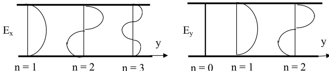
Чем меньше  $n$ , тем ниже критическая частота  $\omega_{кр}$ . При  $n = 0 \rightarrow \omega_{кр} = 0$ , в этом единственном случае в плоском полом волноводе распространяется плоская однородная волна, лишенная продольной компоненты поля.
