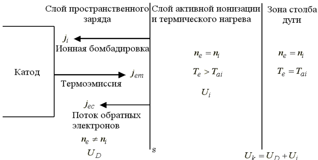
Рис. 11. Схема двухслойной модели прикатодной области дуги.
