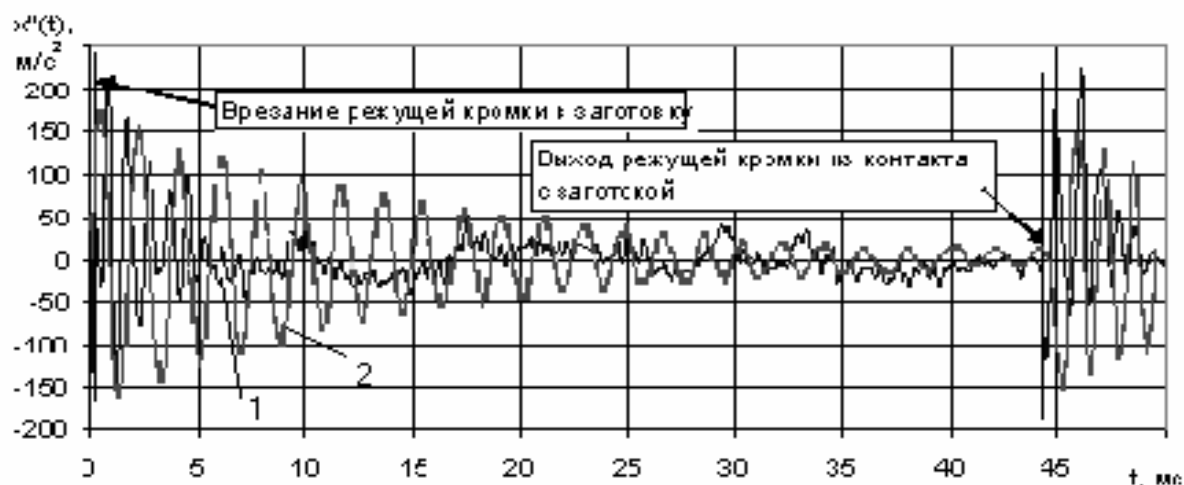
Рис. 6. График ускорений стального корпуса фрезы: 1 - экспериментальная кривая; 2 - теоретическая кривая, полученная по программе
