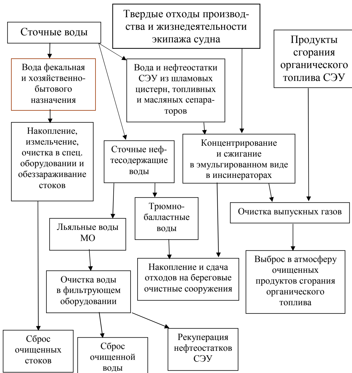
Рис. 1. Источники загрязнения окружающей среды на водном транспорте
