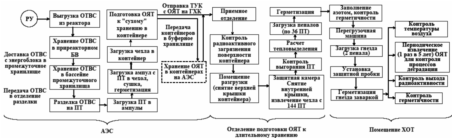
Рисунок 12 – Технологическая схема обращения с ОЯТ РБМК
