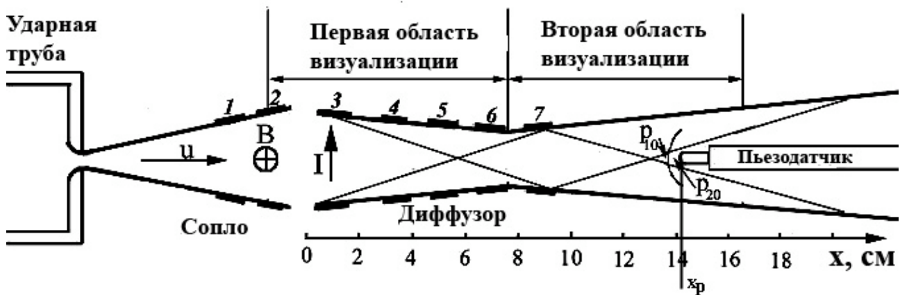
Рис. 1. Газодинамический тракт и схема обтекания датчика давления. Цифры – номера электродов.
