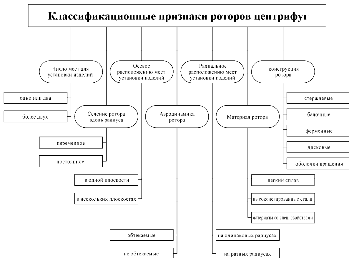
Рис.1. Классификационные признаки роторов центрифуг
