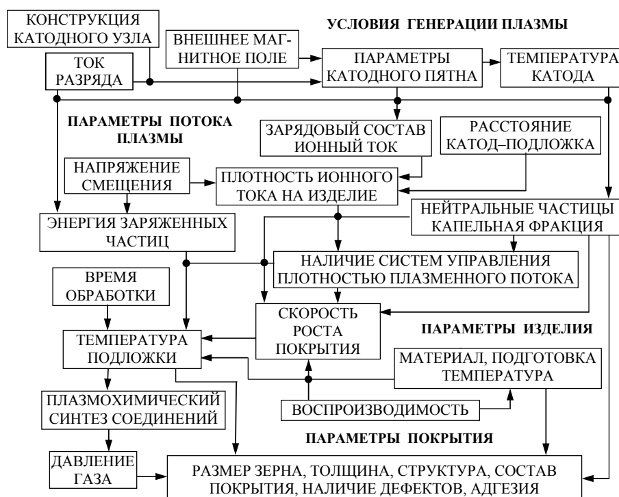
Рис. 1. Схема взаимосвязи параметров, определяющих процесс формирования покрытия из металлической плазмы вакуумно-дугового разряда
