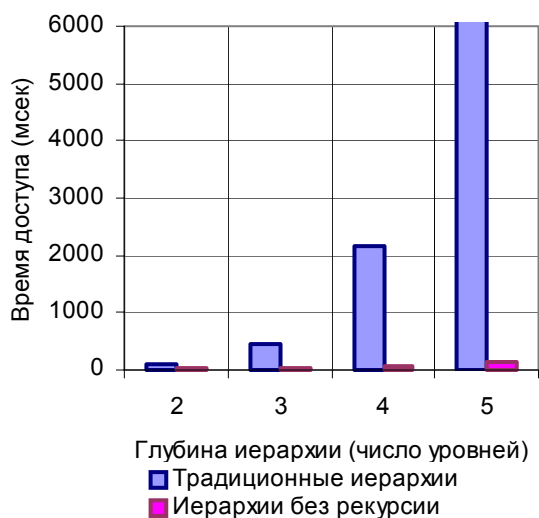
а) зависимость времени доступа от глубины иерархии
