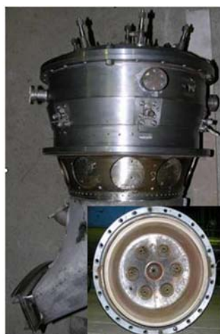
Рис. 7. Эволюция камер сгорания при создании ГТУ среднего класса мощности
