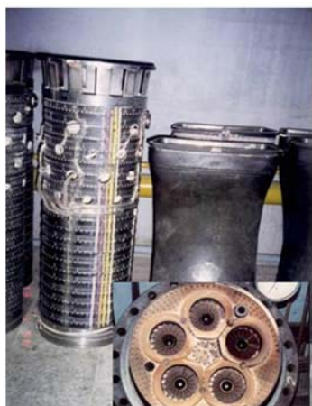
Рис. 7. Эволюция камер сгорания при создании ГТУ среднего класса мощности
