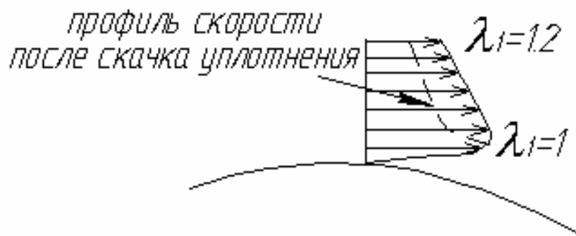
Рис. 4.19.4. Профили скорости перед и после скачка уплотнения
