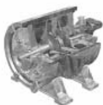
Рис. 1.3.13. Трехмерный модельный чертеж центробежного компрессора 10 мПа, (МНО) обдува на объекту кафедры КИСТ (КИСТУ)
