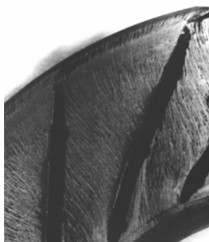
Визуализация вторичных течений на поверхности покрывающего диска центробежного рабочего колеса
