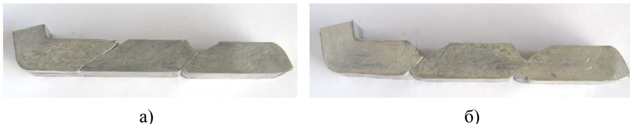
Рис.10. Форма образцов после непрерывного РКУ-прессования при использовании различных типов смазки: а) смазка №3; б) смазка №6.
