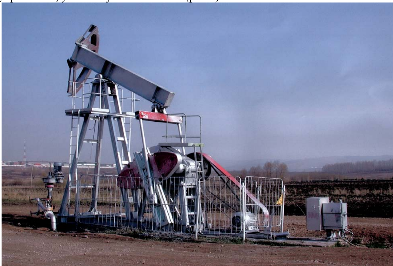
Рис.3. Общий вид штанговой скважинной насосной установки и винтовой насосной установки и станций управления на скважине № 9008 НГДУ "Заинскнефть".
