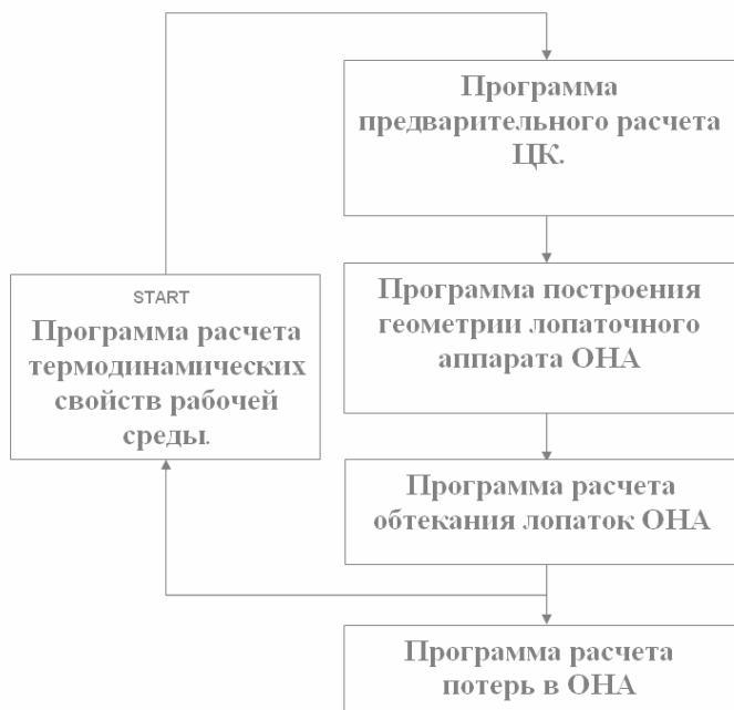
Рис.1 Структура программного комплекса построения и оценки эффективности ОНА центробежного компрессора высокого давления
