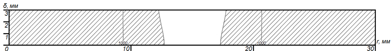
Рис. 7. Расчетное распределение температуры ( ^{\circ}\text{C} ) в металле анода (X18H9T) под действием сжатой дуги ( I=150\text{ А} ; G_{\text{пл}}=3\text{ л/мин} ; d_c=4.2\text{ мм} ; L_d=15\text{ мм} )
