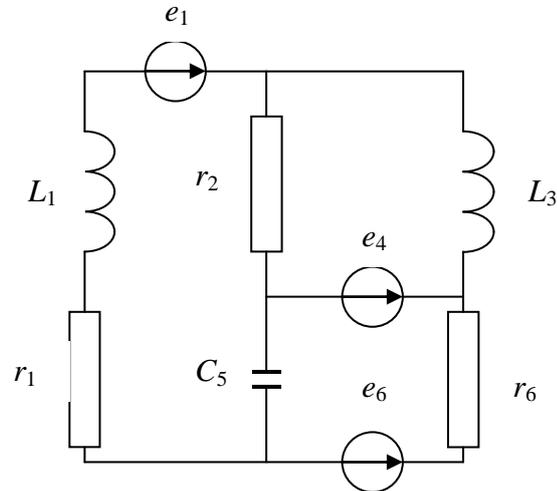
В электрическую цепь включены источники гармонических колебаний.
