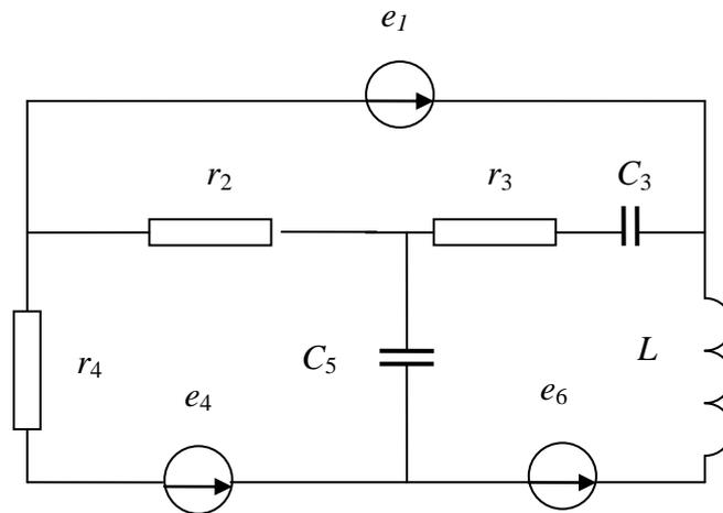
В электрическую цепь включены источники гармонических колебаний.
