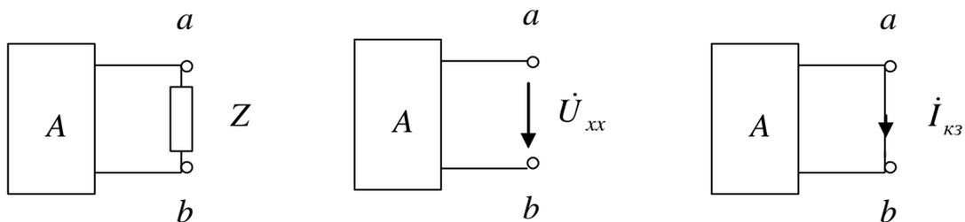
Когда найдены значения  $\dot{E}_Г$  или  $\dot{\mathcal{I}}_Г$ , ток в ветви между узлами  $a$  и  $b$  определяется для той или иной электрической цепи:
