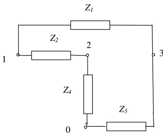
При выключении источника тока ветвь, содержащая такой источник, размыкается (ветвь между узлами 2 и 3).
