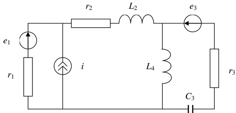
В электрическую цепь включены источники гармонических колебаний.
