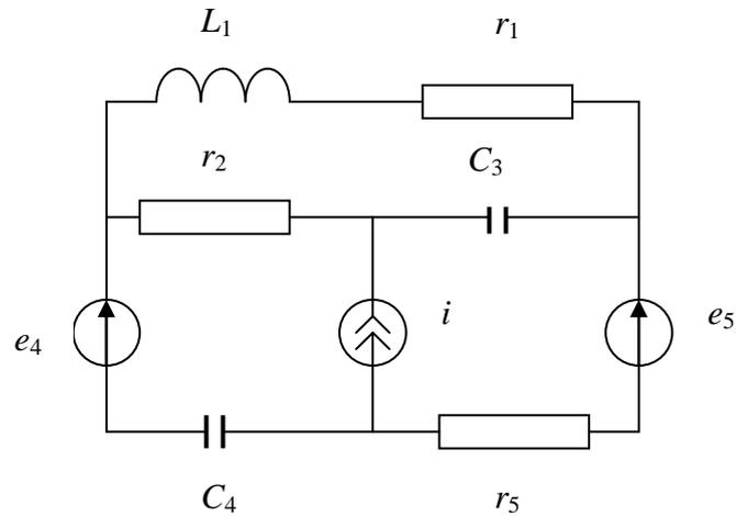
В электрическую цепь включены источники гармонических колебаний.
