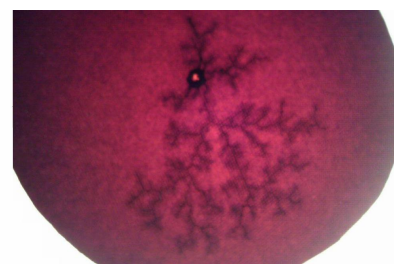
Рис. 2. Характерный след развития ползущего разряда
