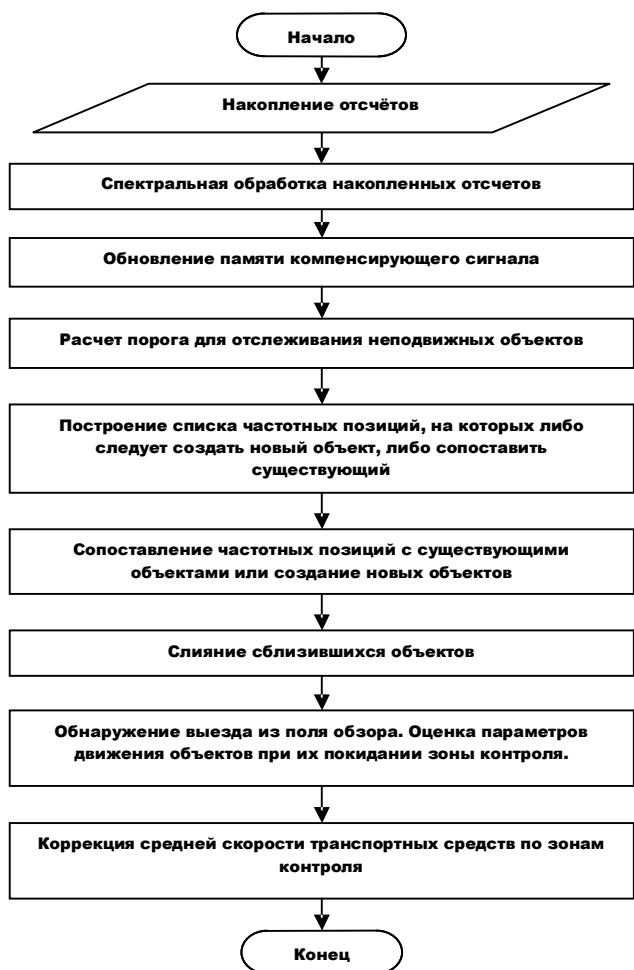
Рис. 3. Алгоритм распознавания ТС и оценки параметров ТП по радиолокационному изображению
