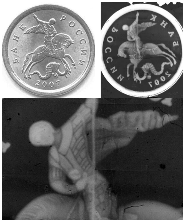
Рис. 16. Монета, её амплитудная реплика в стекле К8 и её фрагмент.
