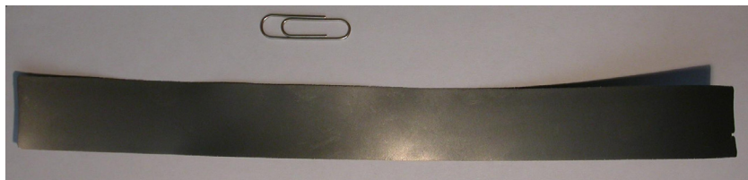
Рис. 3.9. Бериллиевая фольга толщиной 30 мкм, полученная методами ИПД
