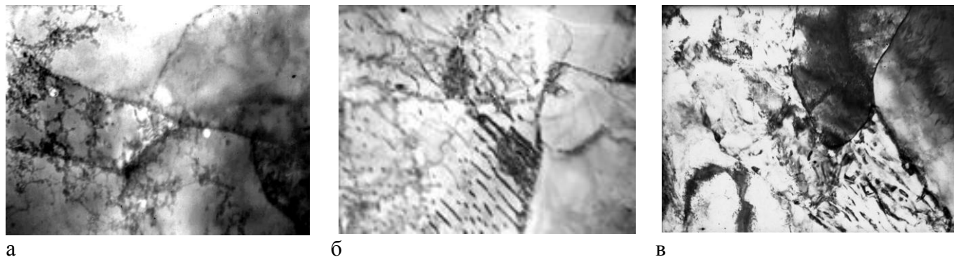
Рисунок 4. Электронно-микроскопическое изображение структуры в поверхностном слое наплавов приготовленных под флюсами ФЦ-16. x 16000 (а), x 24000 (б,в)
