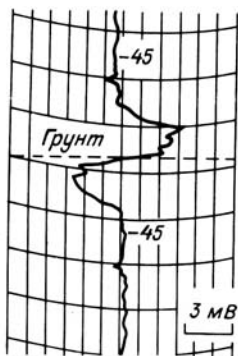
Рис. 2.42. Зависимость формы импульса \Delta\varphi_z от характера грунтов в Ладожском озере:
