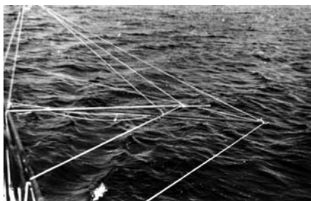
Рис. 2.10. Приспособление для выноса зонда за борт э/с “Лимнея”. 1973–1975 гг.
