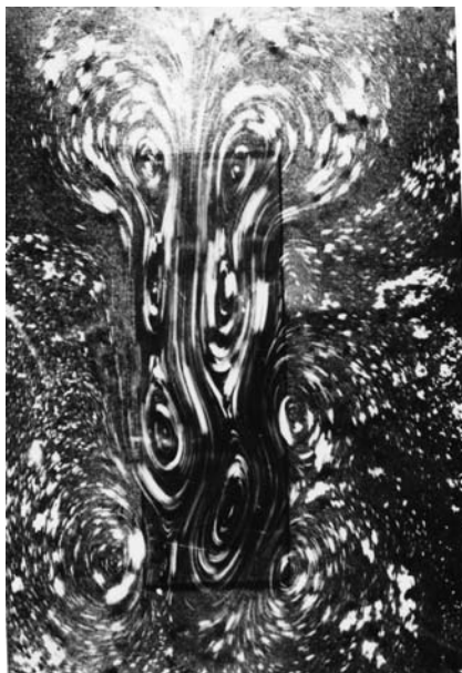
Рис. 2.31. Моделирование стокового МГД-течения с помощью эластичных магнитов с линейчатой структурой, J = 320 мА, V = 0,3 см/с
