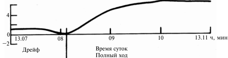
Рис. 2.14. Эффект трибополяризации на электродной буксируемой установке за кормой судна в штилевую погоду на Ладожском озере: а — режим: остановка—ход; б — режим: дрейф—полный ход
