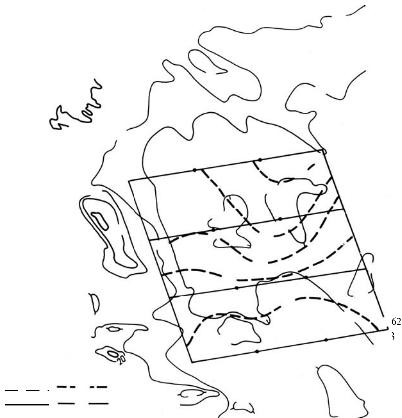
Рис. 2.32. Карта-схема изменчивости уровня потенциала условно “нормального электрического поля” в северной части Ладожского озера:
