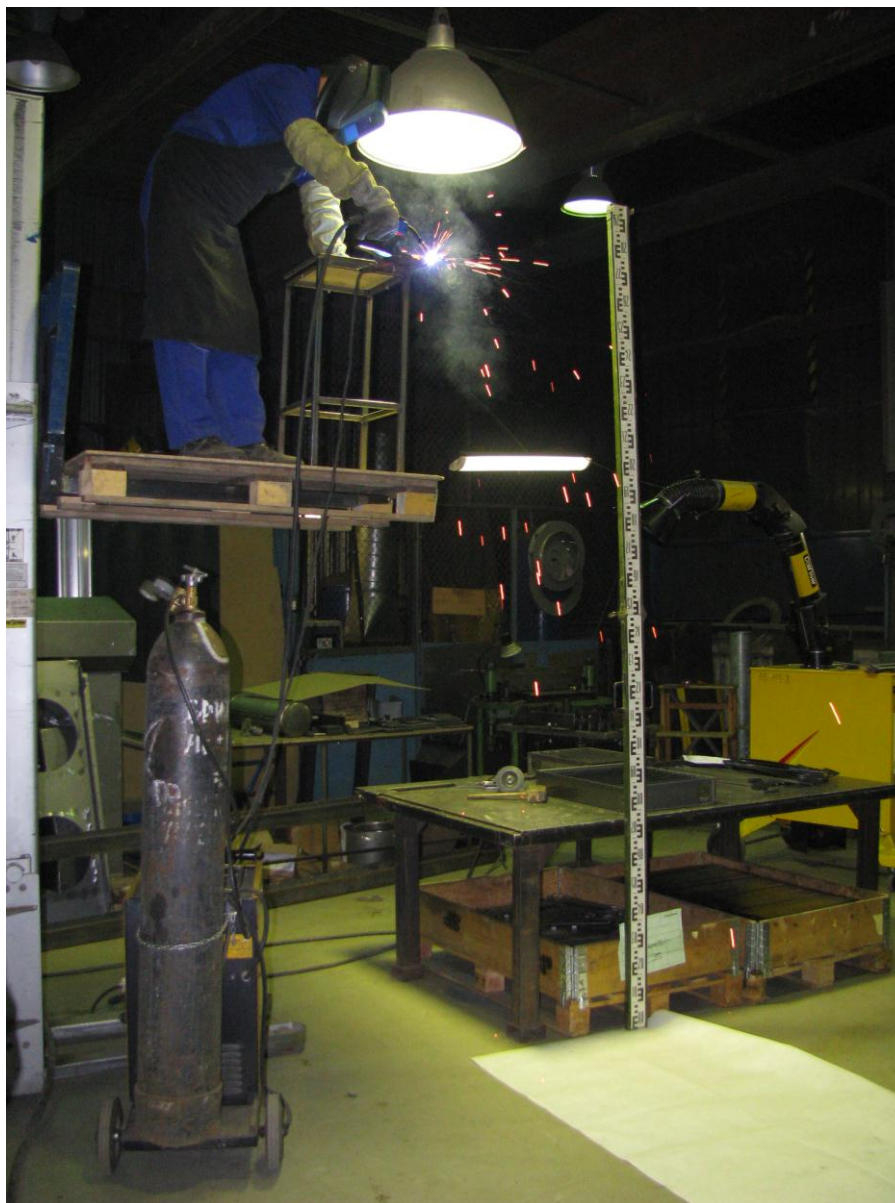
Рис. П.1. Измерение гравитационной гидравлической крупности w частиц пыли, выделяющихся при сварочном производстве
