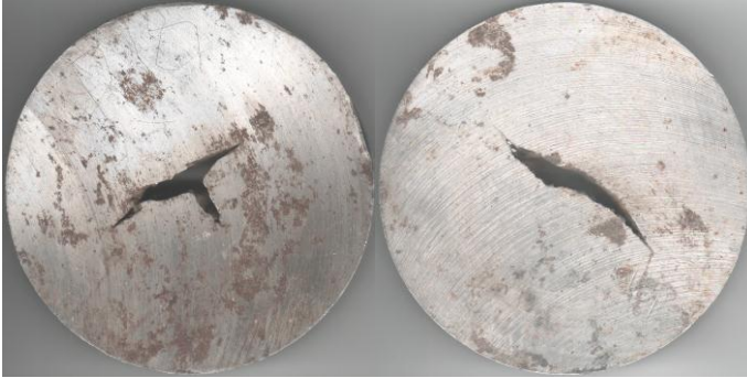
Рисунок 16 – Темплет вала с «развитым» осевым дефектом сплошности
